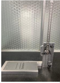
Hình 6.3: Cơ cấu cân bằng trọng lực
